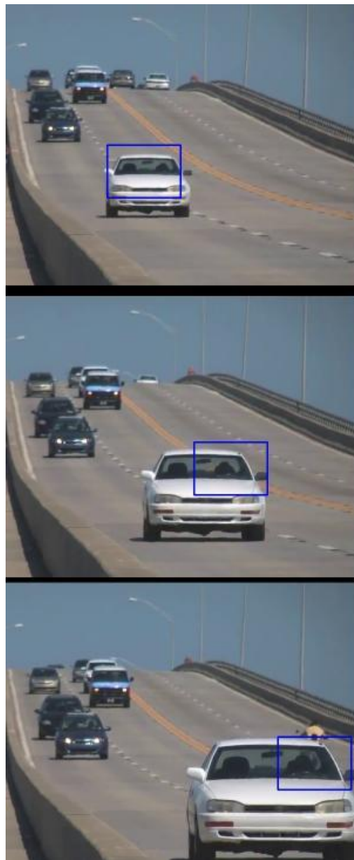
Рисунок 2.11 – Відстеження позиції автомобіля за допомогою алгоритма meanshift
