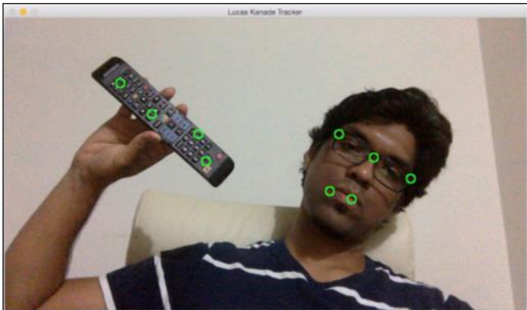
Рисунок 2.9 – Відстеження особливих точок за допомогою пірамідального методу Лукаса-Канаде.
